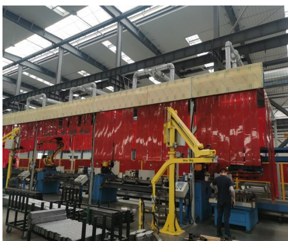
焊接烟尘治理设施 (滤筒除尘器)
