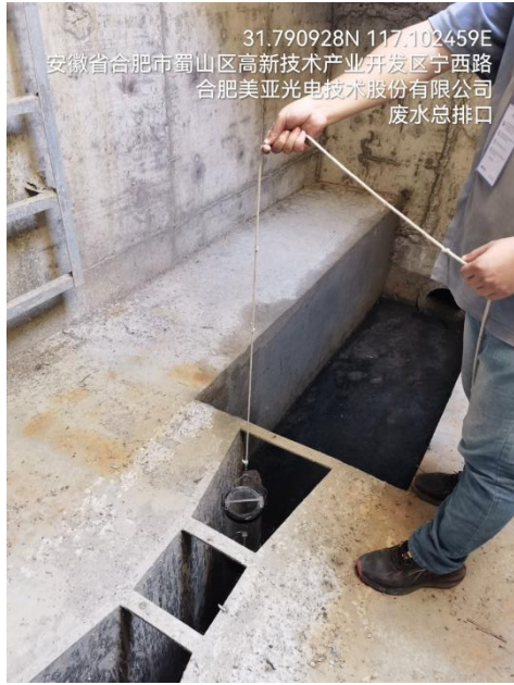
废水总排口检测点位
